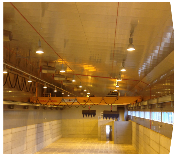
2. MOVIMENTAZIONE DEL MATERIALE CON CARROPONTE AUTOMATICO, SENZA NECESSITÀ DI SEPARARE I SETTORI
