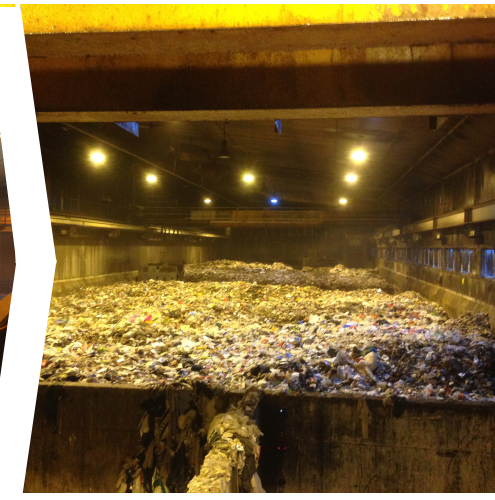
2. MOVIMENTAZIONE DEL MATERIALE CON CARROPONTE AUTOMATICO, SENZA NECESSITÀ DI SEPARARE I SETTORI
