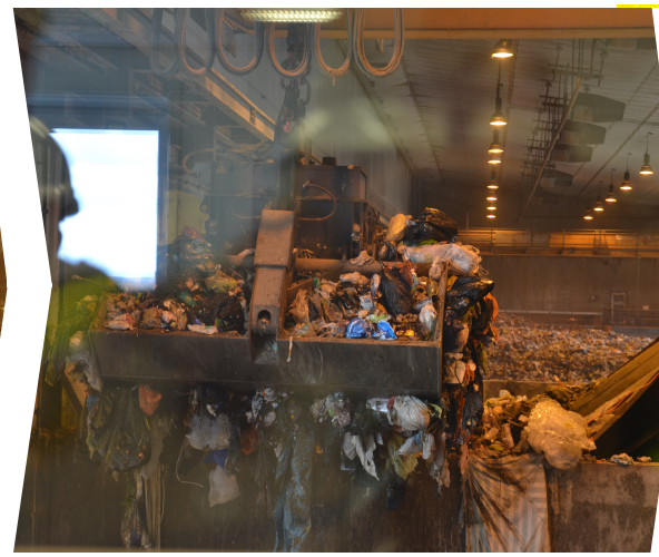
2. MOVIMENTAZIONE DEL MATERIALE CON CARROPONTE AUTOMATICO, SENZA NECESSITÀ DI SEPARARE I SETTORI
